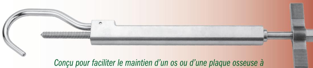
*Conçu pour faciliter le maintien d'un os ou d'une plaque osseuse à des fins de fixation, le clamp est introduit devant l'os, pivoté pour s'enrouler autour de l'os, puis vissé dans la position voulue*
